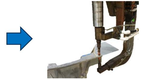
鋼板をスポット溶接した製品
