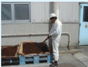
汚泥を乾燥させる作業
