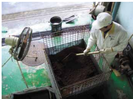
汚泥の回収作業
