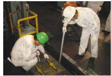
側溝へ流入した作動油の回収状況の様子
