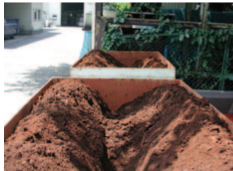
排水処理から発生する汚泥は再生砂化されます
