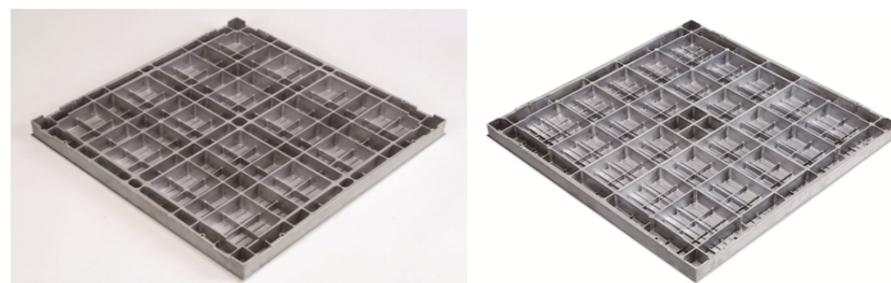
フリーアクセスフロアとは配線・配管を床下に納める二重床システムです。当社では半導体生産工場などのクリーンルームやデータセンターに注力しています。アルミダイカストメーカーの高い技術力を活かし、最軽量フリーアクセスフロアを商品化。アルミダイカスト単一材のため100%リサイクルであり、軽量化により輸送に伴うCO2削減効果、建築胴体躯体への重量負担軽減による長寿命化に貢献。
