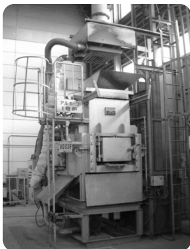
小型溶解炉の廃熱利用
